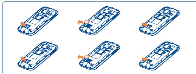
Schieben Sie die Halterung für die microSD-Karte in Pfeilrichtung und heben sie an. Setzen Sie anschließend die microSD-Karte mit dem goldenen Kontakt nach unten ein. Klappen Sie die Halterung für die microSD-Karte wieder herunter und schieben diese in die entgegengesetzte Richtung, um sie zu verriegeln.
