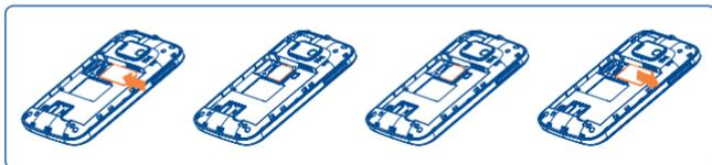
Schieben Sie die SIM-Karte mit dem Chip nach unten weisend ins Gehäuse. Überprüfen Sie, ob die Karte korrekt eingesetzt ist. Drücken Sie zum Entnehmen auf die Karte und ziehen sie heraus.
