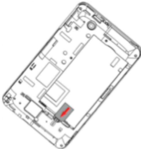
3. Schieben Sie die Speicherkarte in den entsprechenden Steckplatz. Die Abbildung über dem Speicherkartensteckplatz zeigt die richtige Ausrichtung der Karte.
