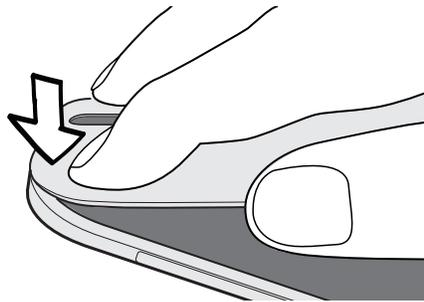
2. Drücken Sie die Seiten und den unteren Teil der Rückseitenabdeckung gegen das HTC One SV, um die Abdeckung an ihrem Platz festzusetzen. Die Abdeckung ist gesichert, sobald sie eingerastet ist.
