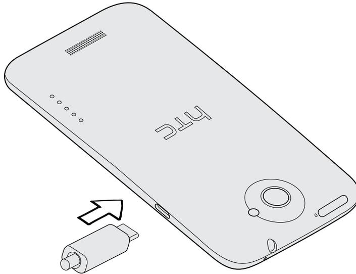
2. Insérez l'autre extrémité du câble USB dans l'adaptateur d'alimentation.
