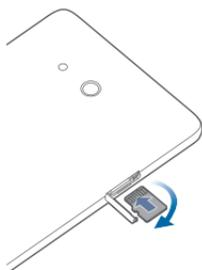
Para instalar la tarjeta microSD, insértela en la ranura de modo tal que quede en la posición adecuada.
