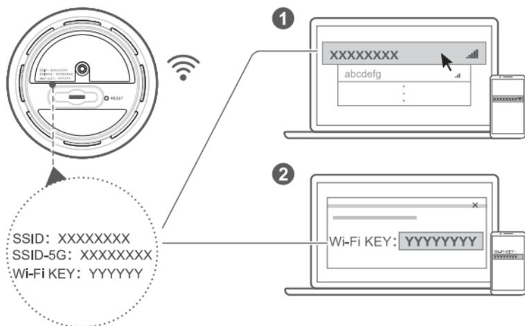
Une fois le routeur connecté à un réseau de données mobiles, vous pouvez connecter votre ordinateur ou téléphone mobile au réseau Wi-Fi du routeur pour accéder à Internet. Veuillez vous référer à l'étiquette située sur la partie inférieure du routeur pour le nom du réseau (**SSID**) et le mot de passe (**Wi-Fi KEY**) par défaut.
