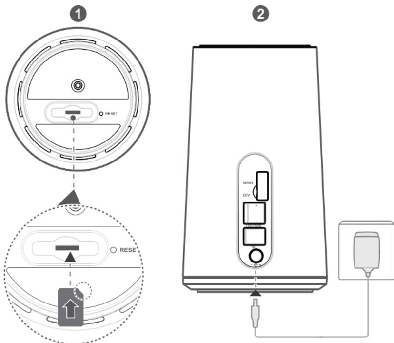
Insérez la micro-SIM dans le logement de la micro-SIM tel qu'indiqué dans le diagramme précédent, puis branchez l'adaptateur d'alimentation sur le routeur B528. Le routeur s'allumera automatiquement et cherchera les réseaux mobiles disponibles.
