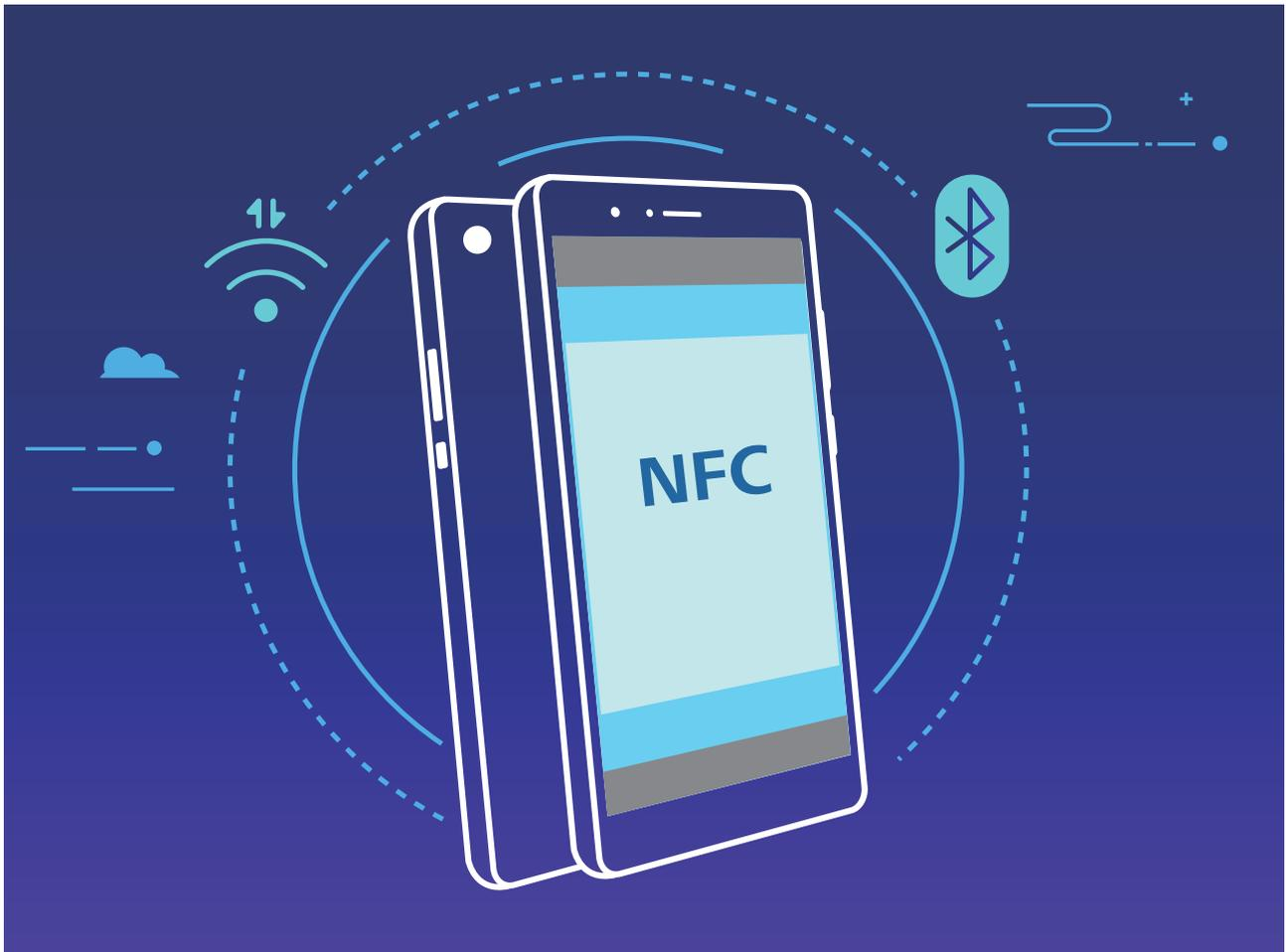
Ad esempio, durante l'associazione di dispositivi Bluetooth, attiva NFC, Huawei Beam e Bluetooth su entrambi i dispositivi. Apri la schermata dell'associazione Bluetooth su entrambi i dispositivi e avvicina le aree di rilevamento NFC dei dispositivi. Quando il dispositivo che trasmette riproduce un prompt audio e lo schermo che trasmette si restringe, segui le istruzioni sullo schermo e tocca quest'ultimo per stabilire una connessione Bluetooth.
