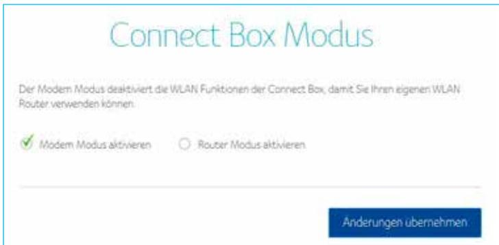
Der Modem-Modus deaktiviert die WLAN-Funktionen der Connect Box, damit Sie Ihren eigenen WLAN-Router verwenden können.
