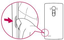
2 Deslice la tarjeta SIM hacia adentro de la ranura para tarjetas SIM, como se muestra en la imagen. Asegúrese de que el área de contacto dorada de la tarjeta quede hacia abajo.
