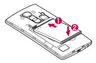
4 Para colocar de nuevo la tapa en el dispositivo, alinee la tapa posterior con el compartimiento de la batería 1 y presiónela hasta que encaje en su sitio 2.
