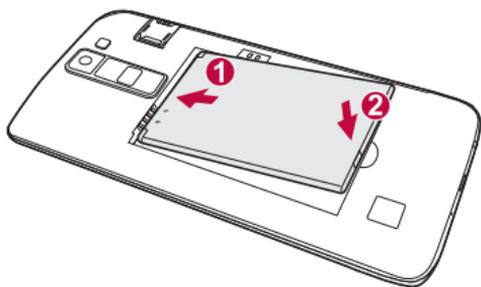
**4** Pour replacer le cache sur l'appareil, alignez la façade arrière sur le compartiment de la batterie et appuyez dessus jusqu'à entendre un clic caractéristique.
