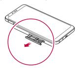
3 Coloque la tarjeta SIM en la bandeja con los contactos de color dorado hacia abajo.
