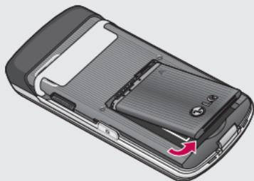
**⚠ LET OP:** verwijder de batterij niet als de telefoon is ingeschakeld; dit kan schade aan de telefoon tot gevolg hebben.
