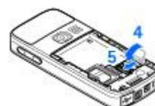
5. Insérez la batterie et remplacez la façade arrière sur l'appareil.
