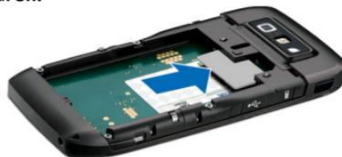
4. Insérez la batterie. Alignez les contacts de la batterie avec les connecteurs correspondants du logement et faites glisser la batterie dans la direction indiquée par la flèche.
