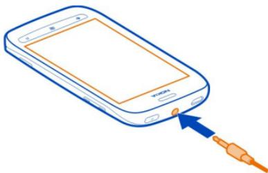
Ne connectez pas de produit créant un signal de sortie, car cela pourrait endommager l'appareil. Ne raccordez aucune source de tension au connecteur audio. Si vous connectez au connecteur audio un appareil externe ou un kit oreillette autre que ceux dont l'utilisation avec cet appareil a été agréée par Nokia, faites particulièrement attention au niveau du volume.
