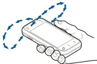
Faites pivoter l'appareil sur tous ses axes en un mouvement continu jusqu'à ce que le voyant de calibration devienne vert 🟢. Si le voyant est jaune 🟡, la précision de la boussole est faible. Si le voyant est rouge 🔴, la boussole n'est pas calibrée.
