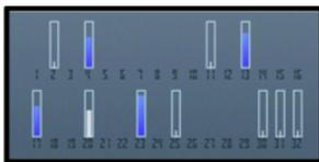
Plus la barre est longue, plus le signal satellite est puissant. Lorsque votre appareil a reçu suffisamment de données du signal satellite pour calculer les coordonnées de votre emplacement, la barre devient bleue.
