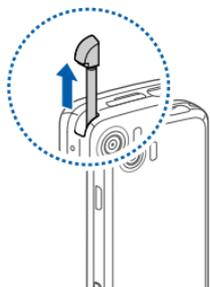
Un emplacement spécial est prévu sur le haut de l'appareil pour ranger le stylet.
