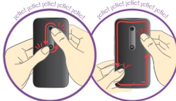
**Precaución:** no utilice ninguna herramienta para retirar la cubierta, ya que podría dañar el teléfono.
