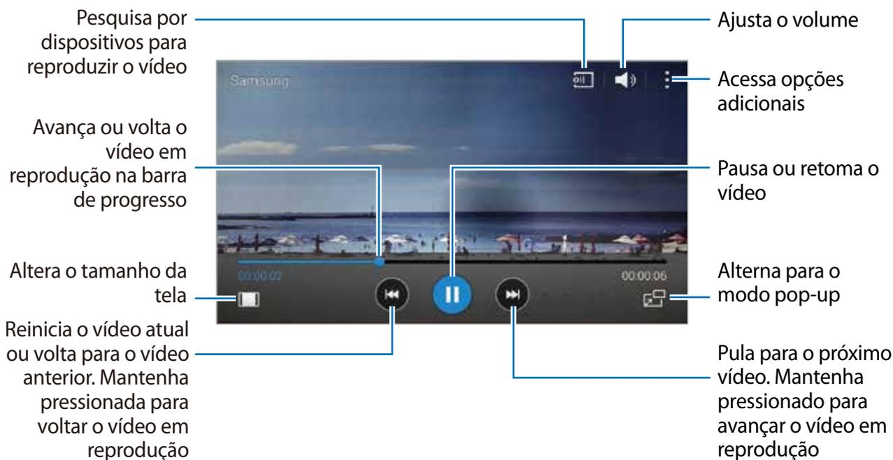
Para personalizar a localização do painel de controle toque em → **Configurações**, marque **Minicontrolador** e depois toque em **Fechar**. Depois toque em ou em para mover o painel de controle para ambos os lados da tela.
