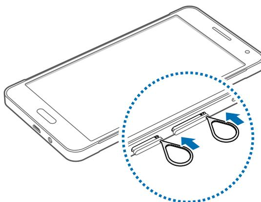
► **Modelos Single chip:** insira o pino de ejeção na abertura do compartimento do chip para afrouxar a tampa do compartimento.
