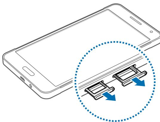
► **Modelos Single chip:** puxe a bandeja do chip gentilmente para fora do compartimento do chip.
