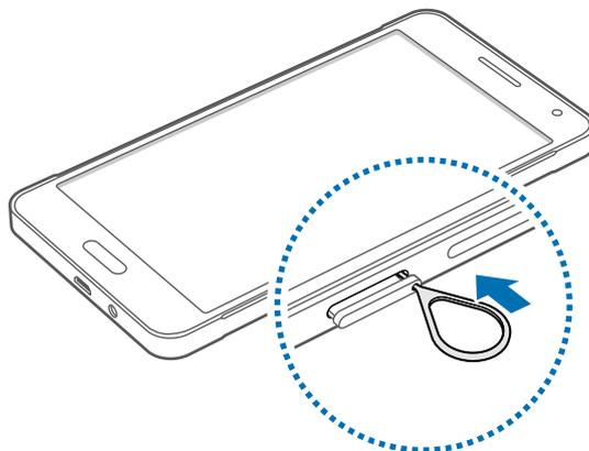
2 ► **Modelos Dual chip:** puxe a bandeja do chip gentilmente para fora do compartimento do chip.
