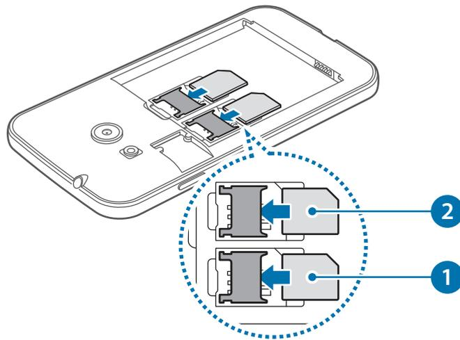
**▶ Modelos Single SIM:** coloque o cartão SIM ou USIM com os contactos dourados virados para baixo.
