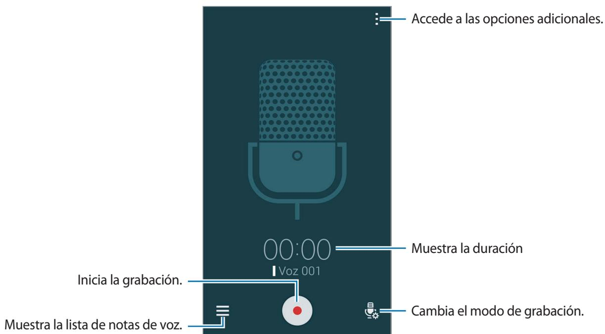
Para configurar el dispositivo para que elimine el ruido de fondo, pulse
