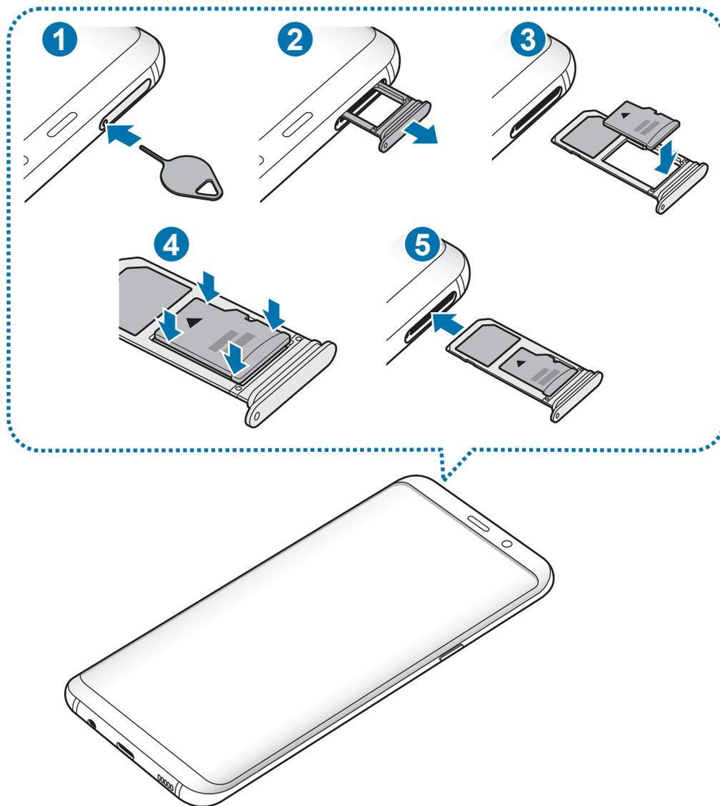
**1** Führen Sie das Steckplatzwerkzeug in die Öffnung am Kartenhalter ein, um ihn zu lösen.
