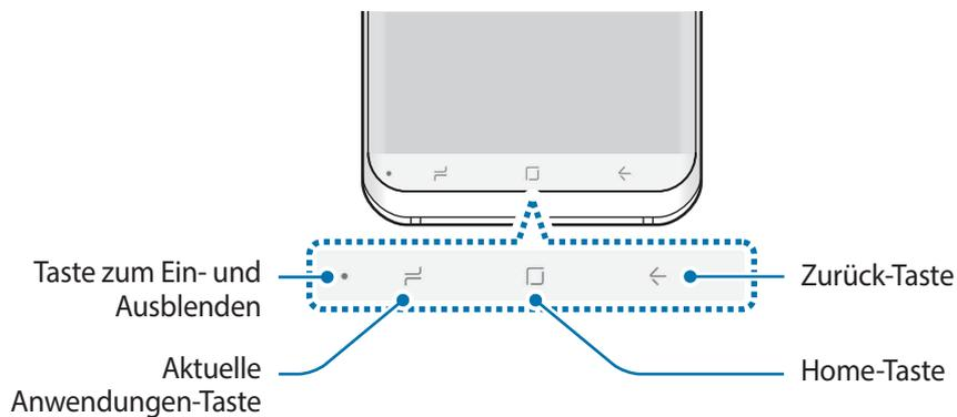
Wenn Sie das Gerät einschalten, werden unten auf dem Bildschirm die Softkeys angezeigt. Die Softkeys sind standardmäßig die Aktuelle Anwendungen-Taste, die Home-Taste und die Zurück-Taste. Weitere Informationen finden Sie unter [Navigationsleiste \(Softkeys\)](#).
