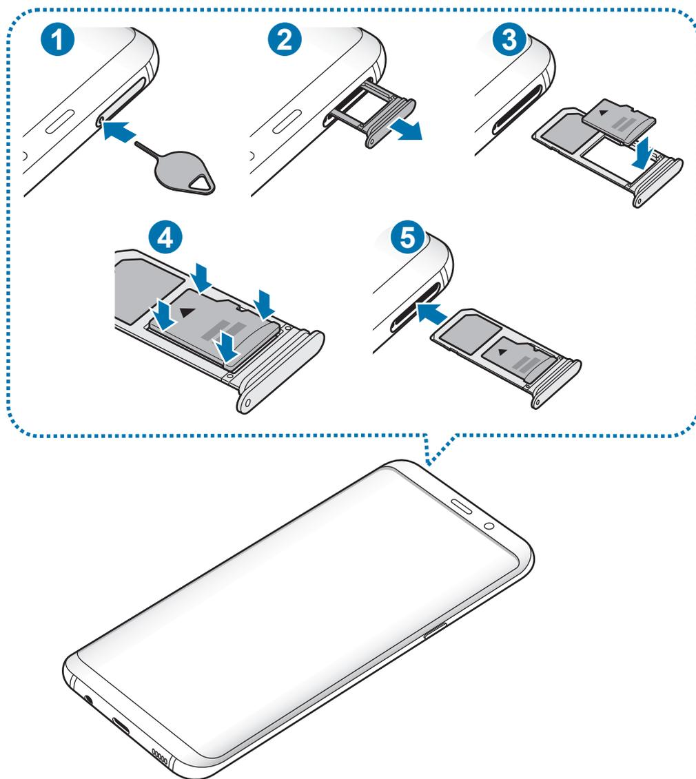
**1** Inserite lo strumento metallico nella fessura per allentare il supporto.
