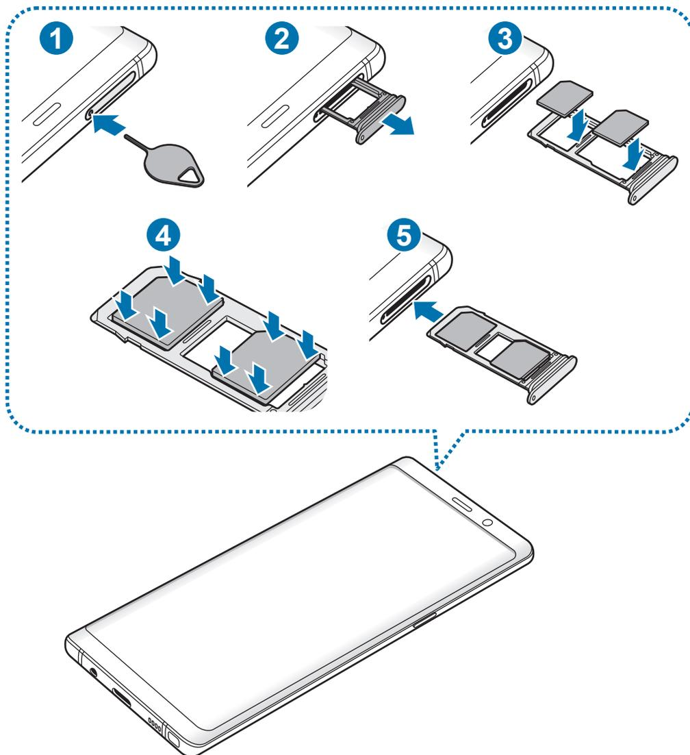
1 Inserite l'estrattore metallico nella fessura del supporto per allentare il supporto.
