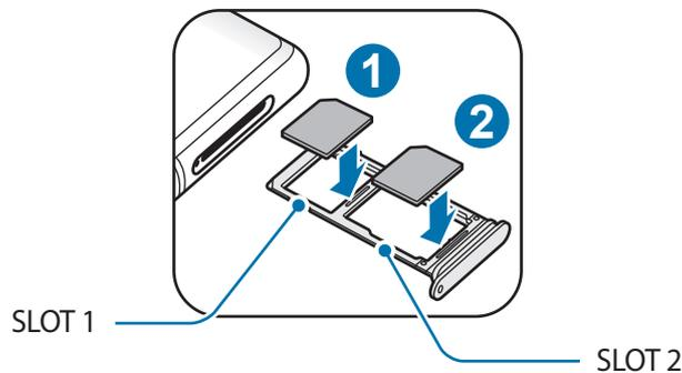
4 Presione suavemente la tarjeta SIM o USIM en el SLOT para ajustarla.
