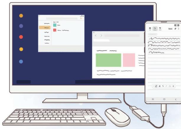
Puede conectar su smartphone con una pantalla externa con un adaptador HDMI (USB tipo C a HDMI) o DeX Pad. El contenido a continuación explica cómo utilizar el adaptador HDMI.
