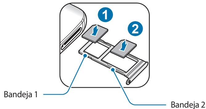
4 Presione suavemente la tarjeta SIM o USIM en el SLOT para ajustarla.
