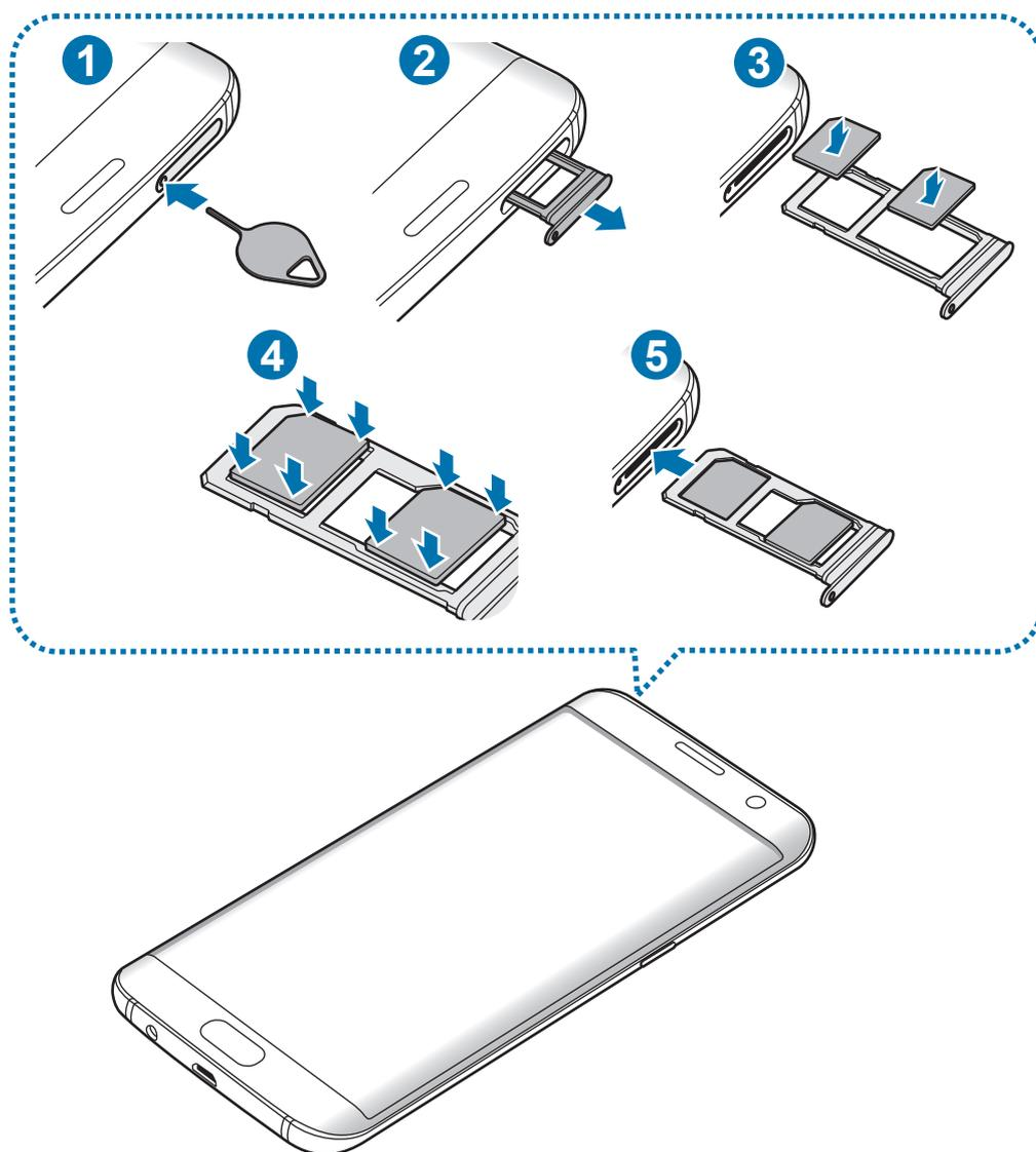
1 Coloque la clavija en el hueco del SLOT para aflojar el SLOT.
