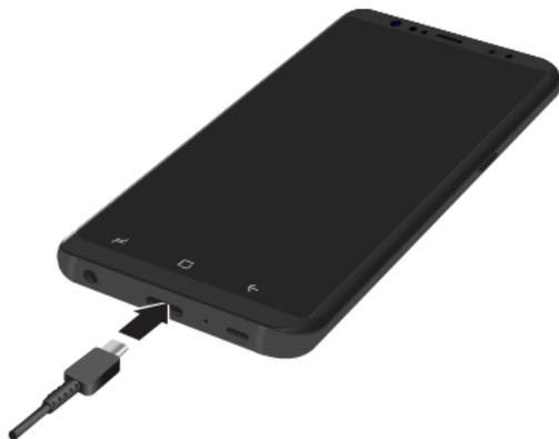
2. Conecte el cable USB a la unidad de carga y después enchufe la unidad de carga a un tomacorriente estándar.
