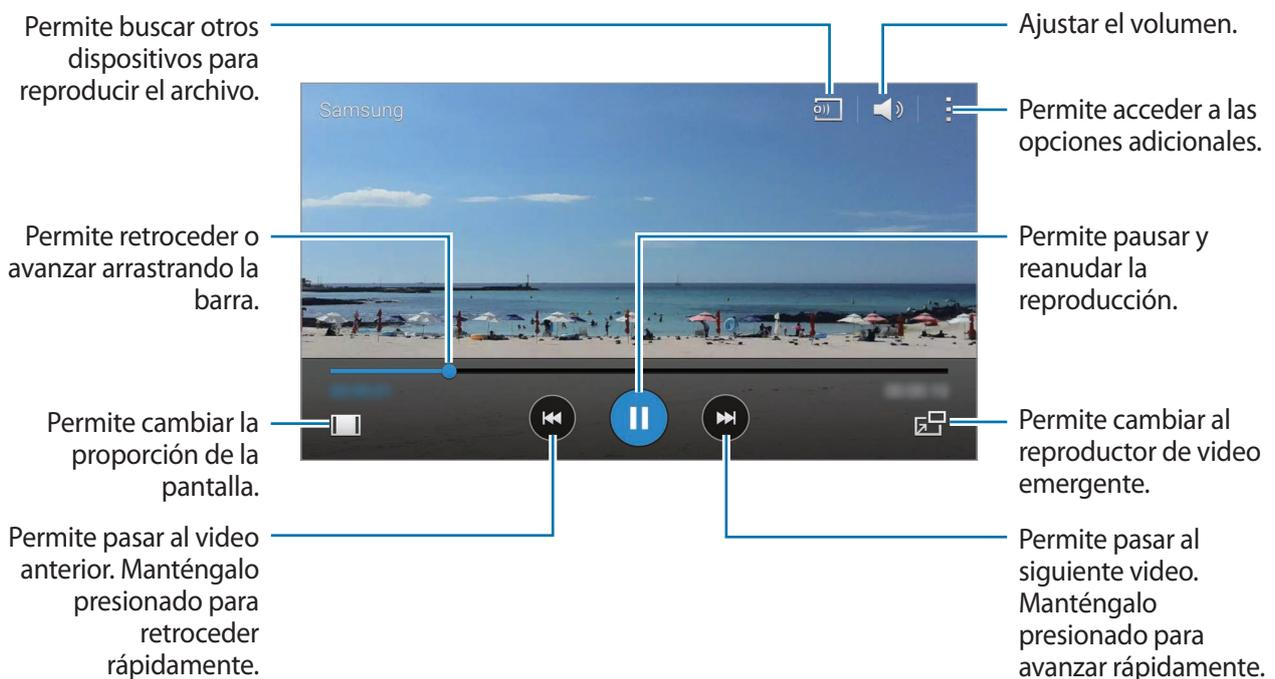
Arrastre el dedo hacia arriba o hacia abajo en el lado izquierdo de la pantalla de reproducción para ajustar el brillo, o arrastre el dedo hacia arriba o hacia abajo en el lado derecho de la pantalla de reproducción para ajustar el volumen.
