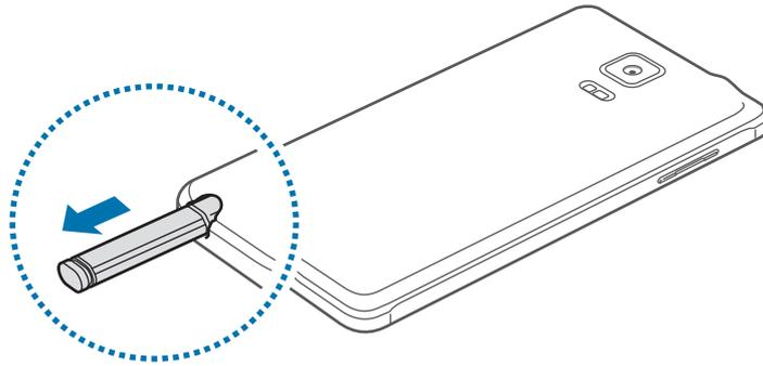
Al retirar el Puntero S de la ranura, el dispositivo iniciará **Nota de acción** o exhibirá las funciones de Air command según la configuración de las opciones para retirar el Puntero S.
