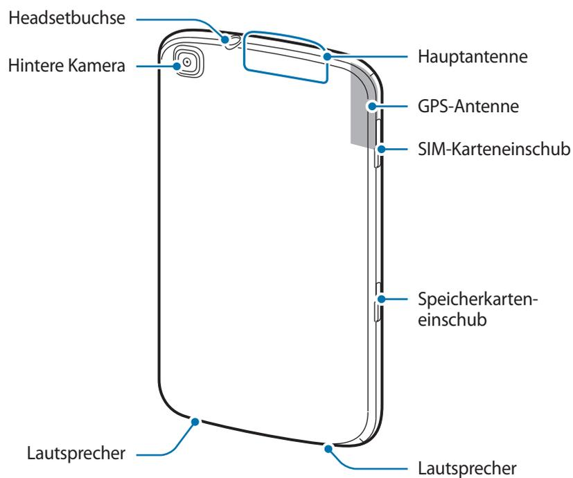
Das Mikrofon, das sich oben am Gerät befindet, ist nur aktiv, wenn Sie den Lautsprecher verwenden oder Videos aufnehmen.
