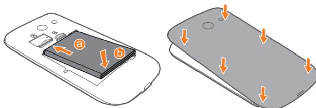
1. Insira o lado **a** (com os contatos metálicos) como indicado na figura no compartimento de bateria.
