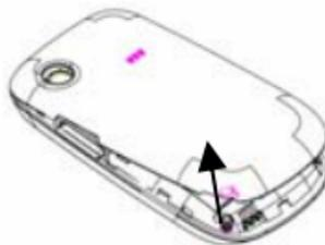
2. Coloque la tarjeta SIM con la esquina orientada como se muestra en la imagen e insértela en la abertura.
