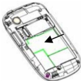
3. Siga la flecha ABIERTA para empujar la ranura de metal, y voltear hacia arriba. Inserte la tarjeta en la ranura de metal con los contactos metálicos hacia abajo hasta que encaje en la posición correcta. Voltear la ranura de metal hacia delante y seguir la FLECHA de bloqueo para bloquear.
